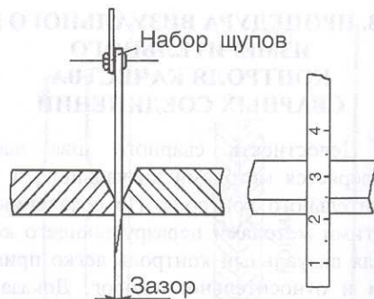
Рис. 8.11. Схема измерения зазора
