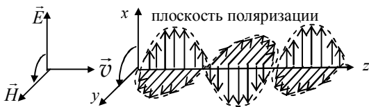
Рис. 10.1. Направления колебаний векторов \vec{E} и \vec{H} в электромагнитной волне
