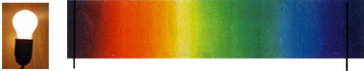
Рис. 8.3. Лампа накаливания и ее спектр испускания.
